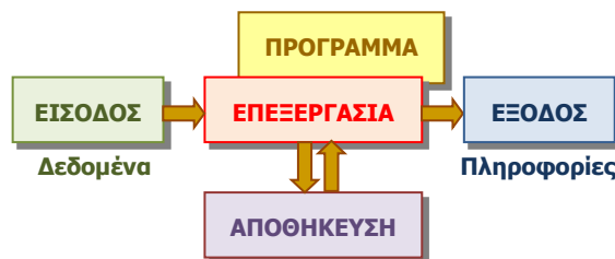
Εικόνα 1 Βασικές λειτουργίες ενός Ηλεκτρονικού Υπολογιστή
