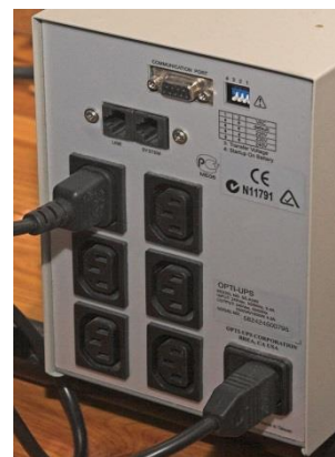
Εικόνα 5 Έξοδοι Τροφοδοσίας IEC
