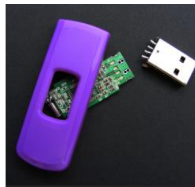
Εικόνα 10 Μνήμη φλάς σε μη λειτουργήσιμη κατάσταση
