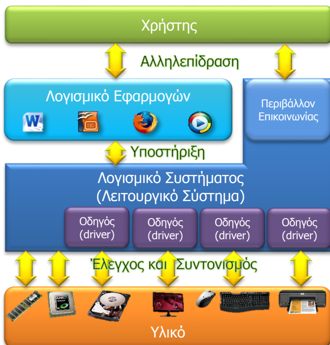
Εικόνα 3 Το υπολογιστικό σύστημα είναι ένα ενιαίο σύνολο και το κάθε μέρος συνεργάζεται με τα υπόλοιπα
