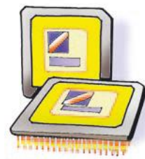
Εικόνα 15 Η Κεντρική Μονάδα Επεξεργασίας
