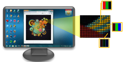
Εικόνα 46 Μια οθόνη αποτελείται από εικονοστοιχεία, το καθένα από αυτά έχει τρεις φωτεινές πηγές, για κόκκινο, πράσινο και μπλε χρώμα
