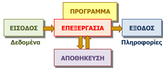
Εικόνα 2 – Βασικές λειτουργίες ενός Ηλεκτρονικού Υπολογιστή
