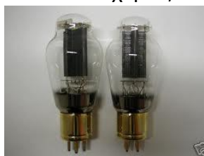
Εικόνα 4 Τεχνολογία Πρώτης Γενιάς: Λυχνίες Κενού
